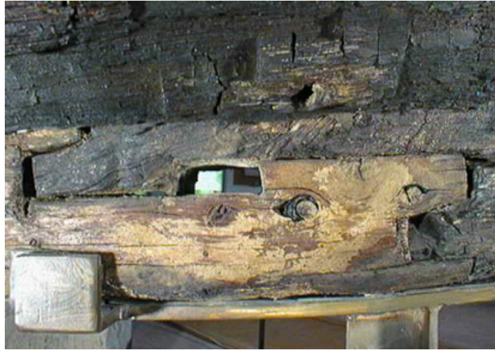
Figura 35: Detalle de unión Diente de Perro de dos elementos de la quilla en Nave Fumicino 3, del S. III D.C. del Museo delle Navi de Fumicino. Fuente: Wolff (2010)
